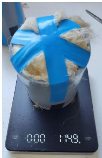
Foto 3. Detall de la compactació de la proveta número 4.
